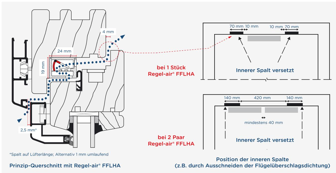
Der Regel-air® Fensterfalzlüfter FFLHA Typ 24 FL wird generell oben im Blendrahmen oder Kämpfer eingebaut. Der Typ 24 RF ist für die senkrechte Montage geeignet (siehe Rückseite). Der Lüfter ist 24 mm tief, 19 mm hoch und 290 mm breit.
