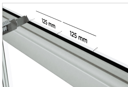
Anzeichnen und Entnehmen der Dichtung im Fensterflügel
