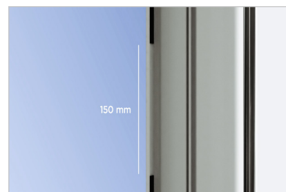
Anzeichnen und Entnehmen der Dichtung im Blendrahmen
