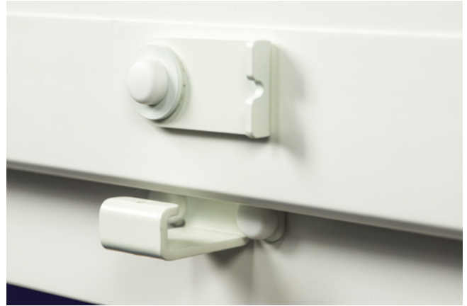
Aushebelsicherung in geöffneter Position. Der FensterRiegel kann durch sein Drehlager mit Drehbremse in jeder Position arretiert werden.
