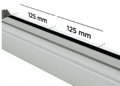
Anzeichnen und Entnehmen der Dichtung im Fensterflügel
