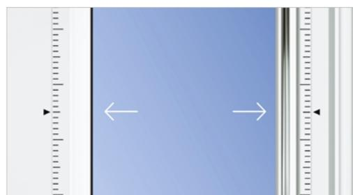
6.) Nun wird mit einem scharfen Cuttermesser mittig im senkrechten Bereich, rechts und links je 150 mm Dichtung weggeschnitten oder komplett entnommen. Werden zwei Lüfter montiert, erhöht sich das Maß auf 300 mm pro Seite. Für die Variante „Hohe Volumenströme“ wird die Zuluft nicht senkrecht, sondern oben waagrecht direkt vor dem Lüfter bzw. den Lüftern hergestellt (bei einem Lüfter 300 mm und bei zwei Lüftern 600 mm).
