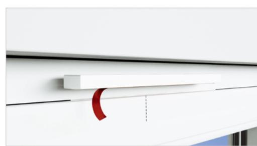
8.) Der FFL-quick wird nun, mit der Klebefläche nach unten zeigend, mittig gegen den Blendrahmen gedrückt.
