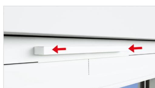
9.) Im Anschluss wird der Lüfter nur noch auf dem Flügelüberschlag fest angedrückt. Der Klebefilm entwickelt in den ersten 72 Stunden die volle Kraft. (Beim Aufkleben darauf achten, dass der FFL-quick direkt über der Dichtungsentnahme positioniert wird.)
